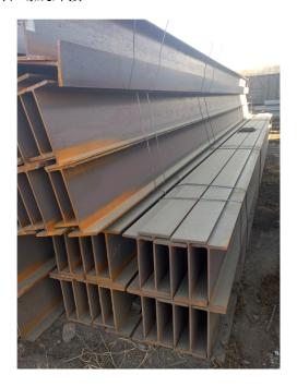
1、首先进行尺寸丈量与尺寸复核; 2、确认尺寸无误后进行放线; 3、预埋件钢连板、节点图现场放样; 4、主梁结构与次梁结构放样定位; 5、现场焊接、加工、钻孔技术细则: 严禁预埋钢连板使用气割开孔,必须使用钻床钻孔。行业技术规范要求: 预埋件钢板钻孔直径允许大于等于螺杆直径的。严禁为了便于好施工,钻大孔。钢结构的主梁结构,主要是依靠钢梁两端的预埋件节点板的作用,如果锚固(锚固是建筑结构加固技术,属于较强的专业,其技术性更强)连接钢板开大孔时,锚杆的螺母与钢板的紧定受力发生变化,此时的刚接板受力就会大打折扣,无法满足结构的需要荷载; 6、主梁H型钢的断切、钻孔加工: ,预埋件用钢板做墙面预埋件做钢梁的链接(用锚栓将钢板锚固)满焊。
